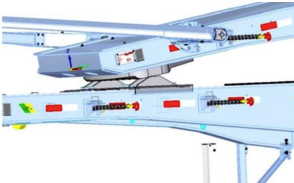
Figura 4: Amarração das cargas na parte da frente, por meio de sistema de pino-rei e quinta roda e de pino específico
