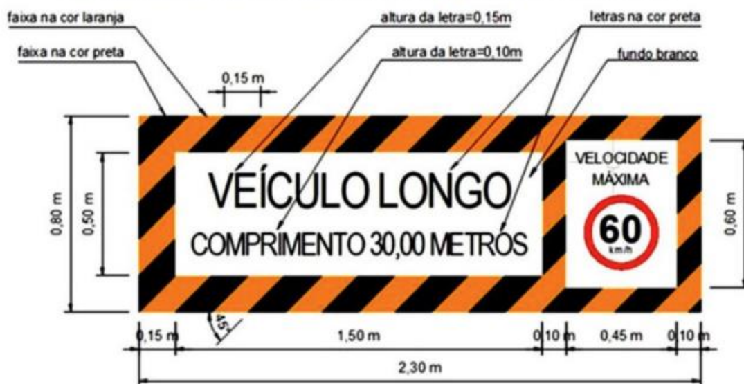
Figura 1: Sinalização especial de advertência traseira para comprimento excedente
